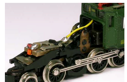
Bild 5: Hier im Detail: Das gelbe Kabel vom Decoder kommend. Sowohl das Krokodil, als auch die E94 haben einen eigenen Lichtanschluss zur Motorplatine. Dieses Kabel wird am Lichtblech abgelötet und durch das gelbe und weiße Kabel vom Decoder ersetzt.
