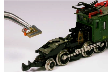
Bild 2: Richtiges Einsetzen des Bausteines – erfolgt im Prinzip wie beim analogen Einbau.
