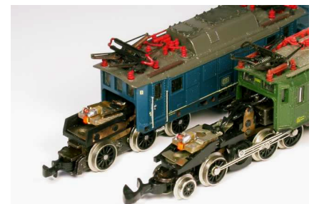
Bild 4: So sieht es dann fertig aus: Baustein eingesetzt (ist sichtbar). Sichtbar auch die Gelbfärbung der weißen LED – so liefern wir die Bausteine für die Altbau E-Loks aus. Nicht sichtbar, die richtige Polarität der unten liegenden Diodenplättchen.
